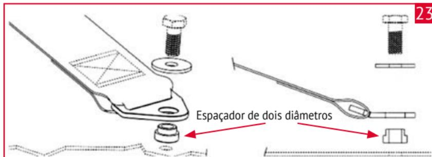
Aperço do colchete com parafuso e espaçador de dois diâmetros
